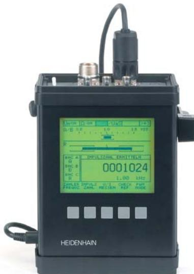
**PWM 18**是一个用于调整HEIDENHAIN公司的增量式编码器的易用的调整工具。在LCD窗口中，信号以相对其公差带的条形图形式显示。
